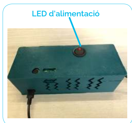
Figura 19: El LED d'alimentació encès indica que la caixa del dormitori està correctament activada.
