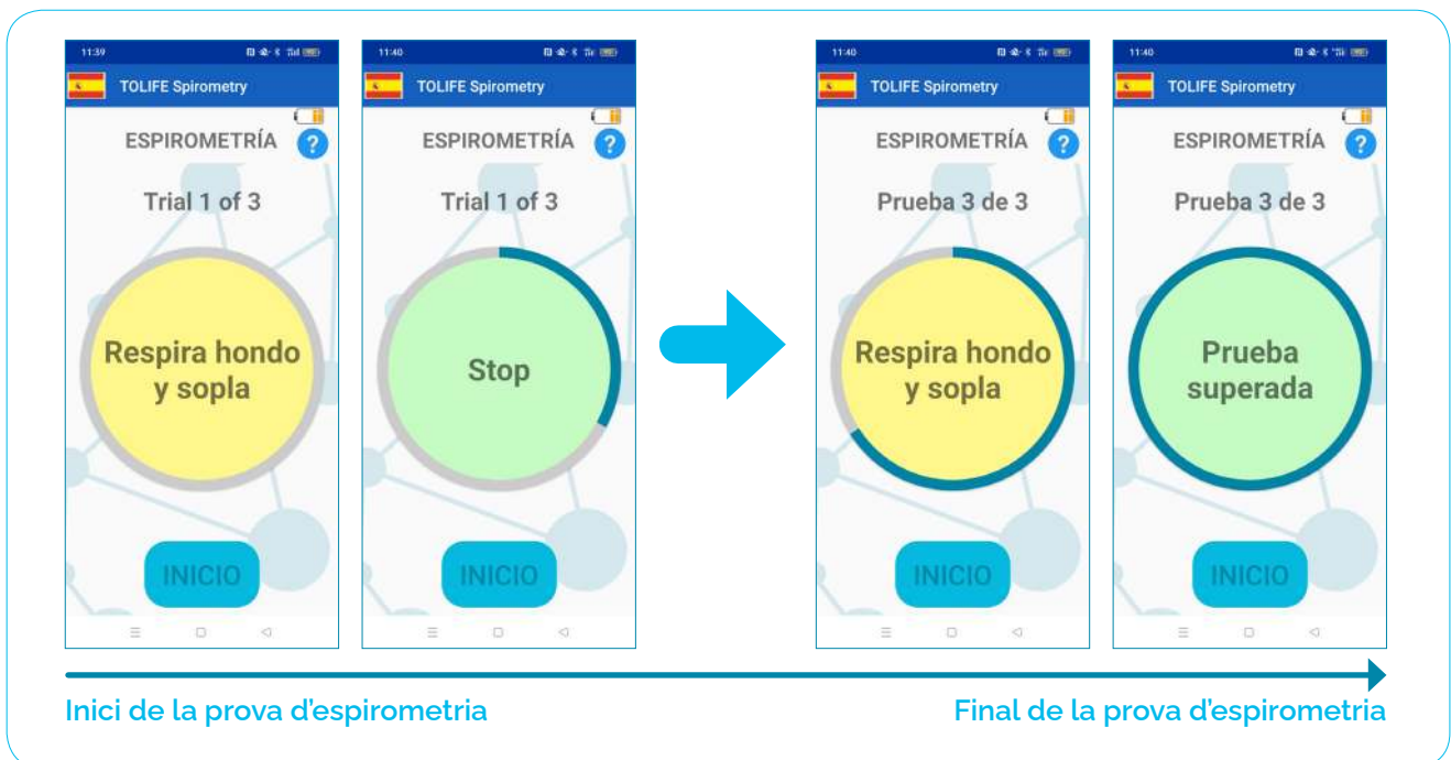
Figura 27: Aquí teniu un exemple d'una prova d'espirometria. La prova consta de tres proves repetides. Una barra de progrés blava envoltarà progressivament el cercle d'instrucció de mesura per informar l'usuari sobre el nombre de proves ja completades. S'ofereixen instruccions simples en el cercle groc / verd (groc: feu una inspiració profunda i bufa, verd: pareu de bufar i descanseu).
