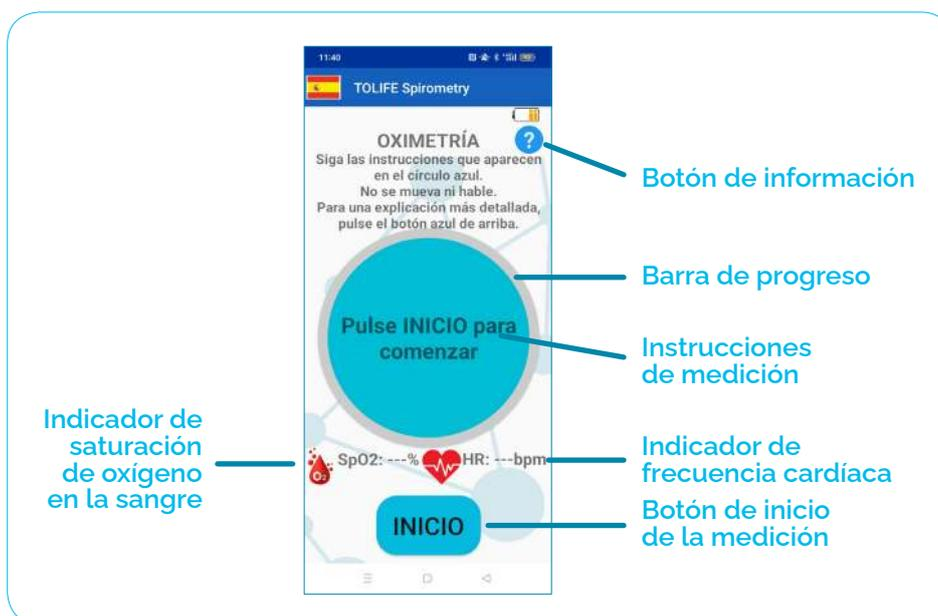
**Figure 29:** Pantalla principal de la prueba de oximetría
