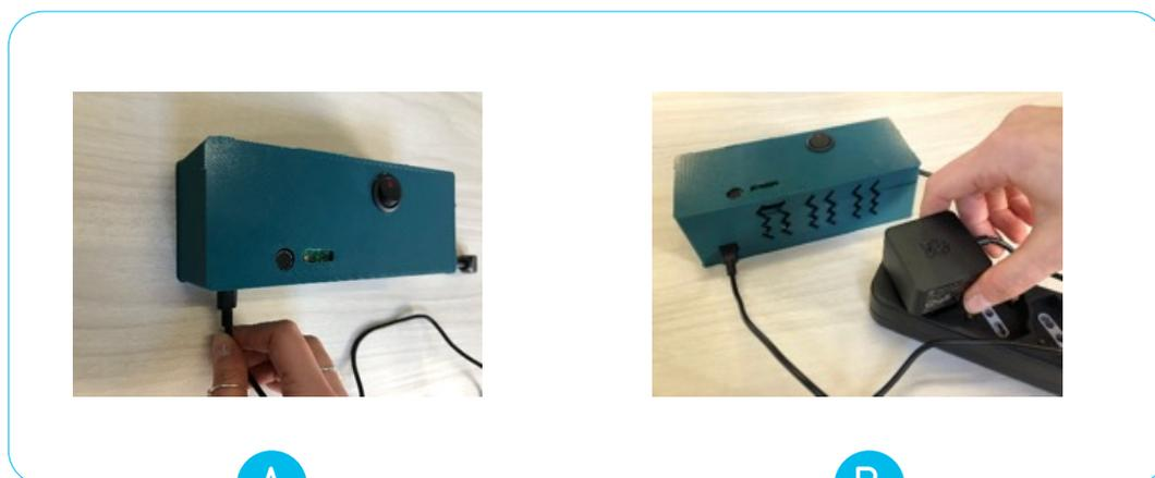
**Figura 18:** A) posizione della porta USB per il cavo di alimentazione
