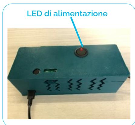
**Figura 19:** Il LED acceso indica il corretto funzionamento della Stazione Ambientale.
