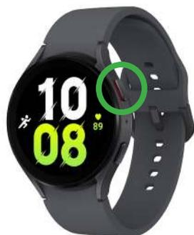
Per la prima installazione, prendere l'alimentatore con cavo e collegarlo a una presa di corrente. Si consiglia di scegliere una presa nella stessa stanza dove tutti gli altri dispositivi saranno caricati e collegati. Accendere lo smartwatch utilizzando il pulsante laterale con un bordo interno rosso (**Figura 5**: tasto indicato dal cerchio verde). Il dispositivo impiegherà un po' di tempo per avviarsi (2-3 minuti).
